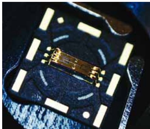
Die Lichtquelle besteht aus einem speziellen Substrat und einer linienförmigen LED in Flip-Chip-Bauweise.
